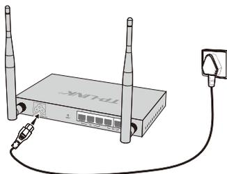
图3-3 电源连接示意图
