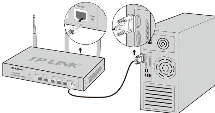
图3-2 Console连接示意图
